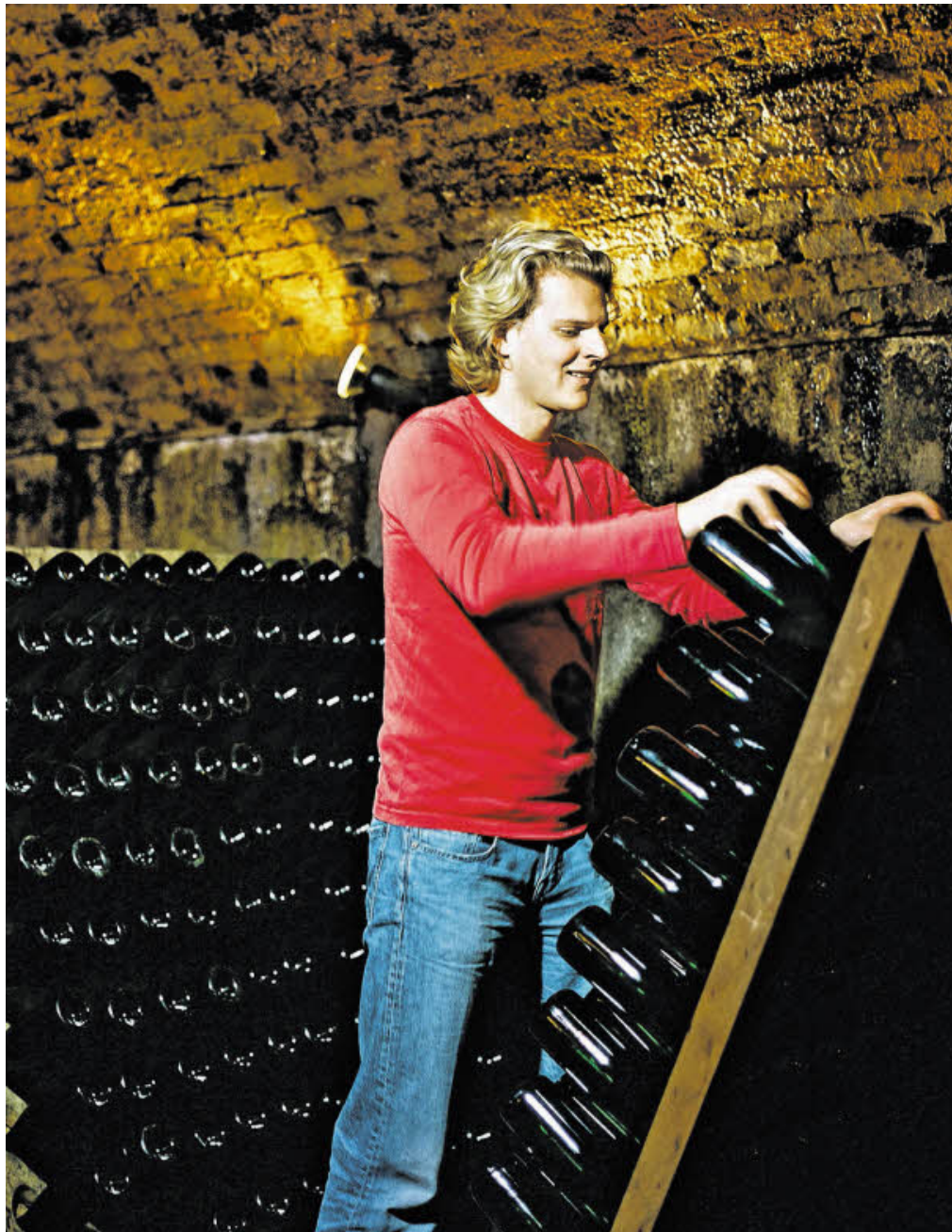
Michael Malat beim Rütteln. Dabei werden die Flaschen Stück um Stück auf den Kopf gestellt, sodass die Hefe in den Flaschenhals gleitet. Von dort wird sie durch Degorgieren entfernt.
